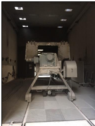
Lackieren einer geschweissten Wanne. Piranha-Wanne bereit zum nächsten Arbeitsschritt
