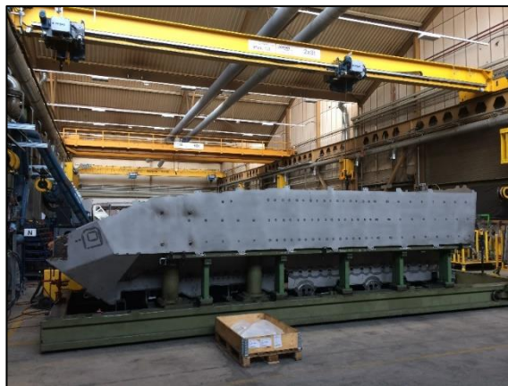
Lackieren einer geschweissten Wanne. Piranha-Wanne bereit zum nächsten Arbeitsschritt
